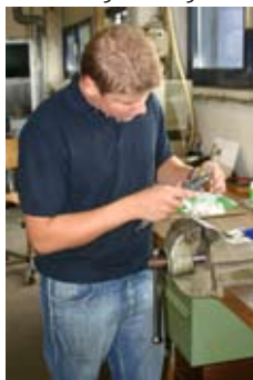
Messen eines Werkstücks mit der Schublehre
