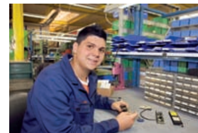
Montage eines mechatronischen Sicherheitszylinders
